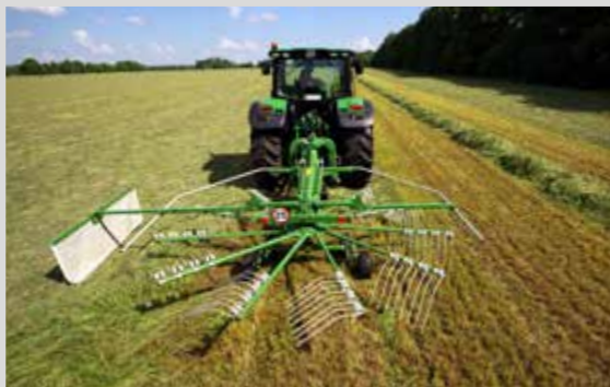
СГРЕБАНИЕ ПОКОСА ПРИ ПОМОЩИ ГРАБЛЕЙ SIPMA ZK 450 WIR
