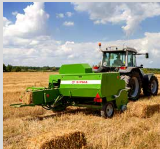
ПРЕССОВАНИЕ СОЛОМЫ ПРЕСС-ПОДБОРЩИКОМ SIPMA PK 4010 KOSTKA
